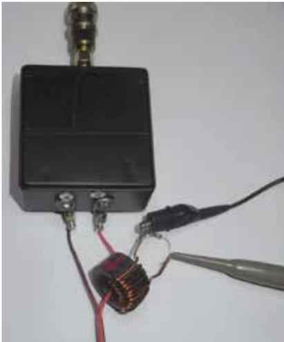
Fig. 6 - Misura della corrente su una linea bilanciata, in questo caso un doppino rosso-nero avente impedenza caratteristica pari a  $150\Omega$ . Come si vede dal "misterioso" scatolino nero, per impiegare le linee bilanciate servono accorgimenti spiegati più avanti nel testo.
